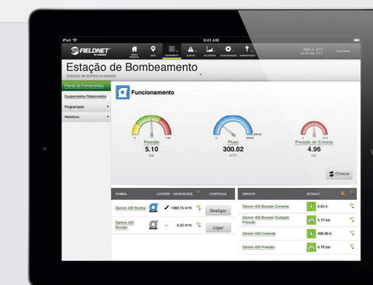
O FieldNET permite a você monitorar e fazer gráficos da taxa de vazão e do volume e define alertas para a disparidade da vazão e a vida da bateria.
