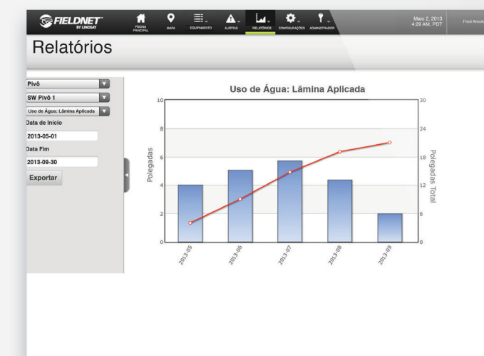
O FieldNET permite a você monitorar e fazer gráficos da taxa de vazão e do volume e define alertas para a disparidade da vazão e a vida da bateria.
